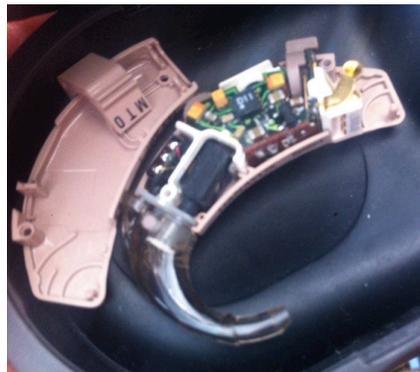
Figura 11. Imagen real de un audífono BTE.
