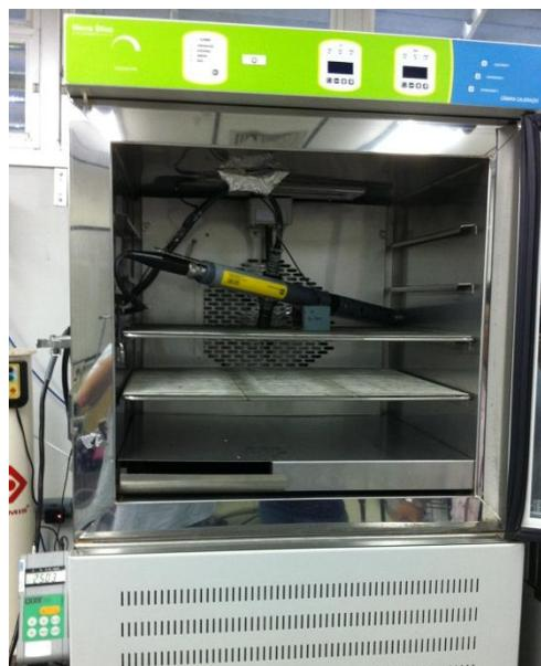
Figura 4.11 - Teste de medição de temperatura com a sonda multiparâmetros.
