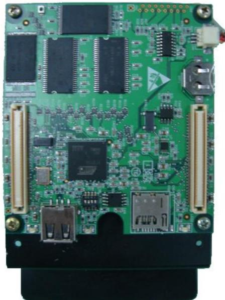
Figura 4.2 - Plataforma Eletrônica para o Microcontrolador SAM9263.
