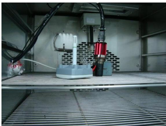
Figura 4.8 - Calibração dos sensores de temperatura e umidade.
