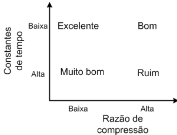
Figura 11 - Qualidade do sinal após a compressão em função das constantes de tempo e da razão de compressão. Adpatada de [16].
