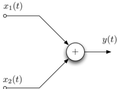
$$\begin{cases} Y(s) = X_1(s) + X_2(s) \\ g^*(t) = x_1^*(t) + x_2^*(t) \\ y(nT) = x_1(nT) + x_2(nT) \\ Y(z) = X_1(z) + X_2(z) \end{cases}$$
